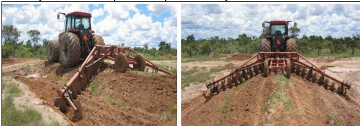
Figura 73 - Construção de terraço de base larga com arado terraceador
