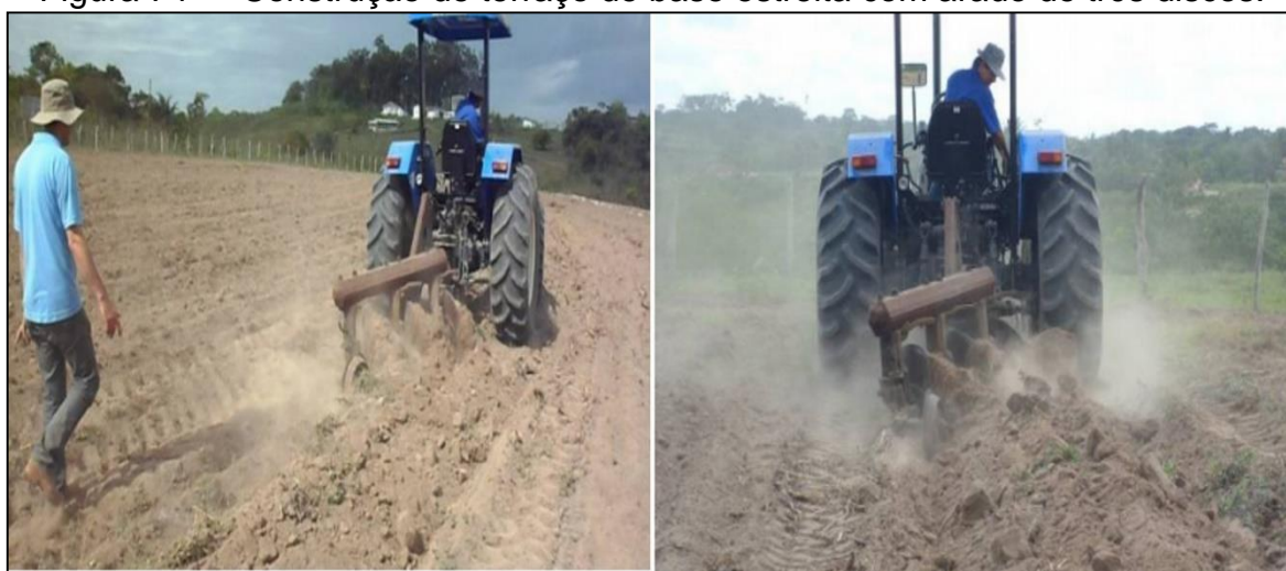
Figura 74 - - Construção de terraço de base estreita com arado de três discos.
